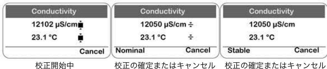
図 7 校正の開始、校正の確定またはキャンセル
