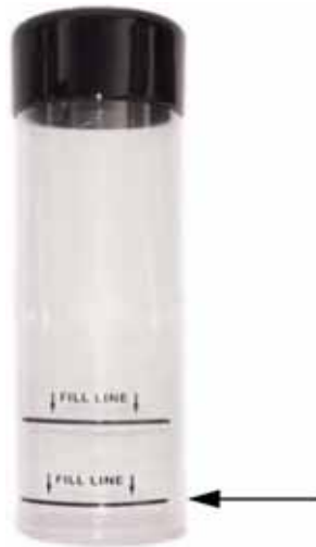
図3 校正容器に下の 10 mL の線まで水を注入
