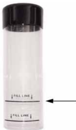
図 5 校正容器に上の 60 mL の線まで水を注入
